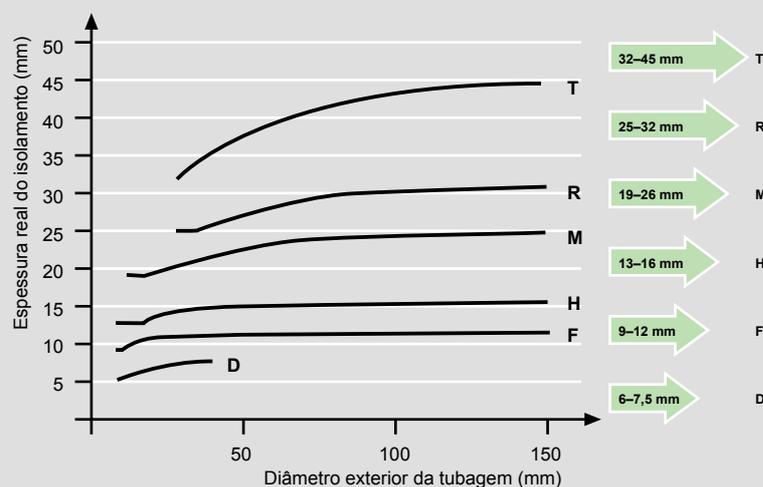
A Armacell mantém as propriedades características do isolamento em todas as coquilhas AF/Armaflex. Para a mesma espessura nominal, conforme aumenta o diâmetro da tubagem, vai aumentando a espessura técnica real do AF/Armaflex. Assim, a sua temperatura superficial é constante.
