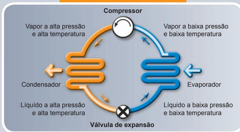
A substituição do gás R-22 - prejudicial para a camada de ozono - requereu a modificação das bombas de calor e sistemas de ar condicionado para poderem trabalhar com os novos gases refrigerantes como o R-410A. Desse modo, o tubo de aspiração dum
